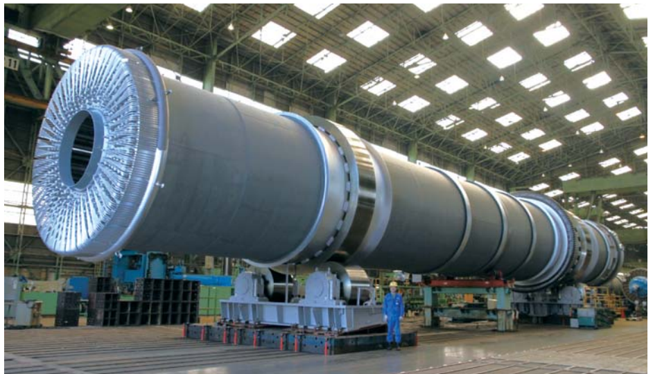
乾燥機の一例 (スチームチューブドライヤー)
